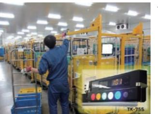
★システムが光と色で取り出す物品を指示し、人による仕分け作業を支援。誰でも早く正確な作業が可能となり、生産性が向上。
